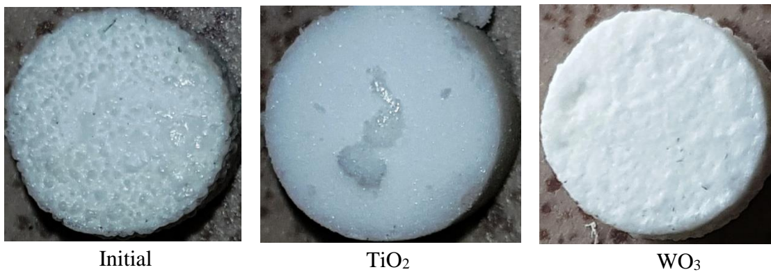
Figura 34. Pastile puse la calcinat la 900 °C timp de 30 de min
