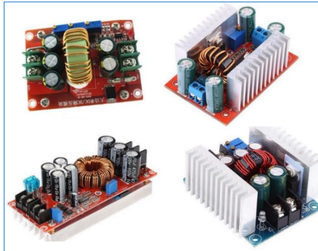
Figura 18. Surse în comutație cu reglajul tensiunii la ieșire
