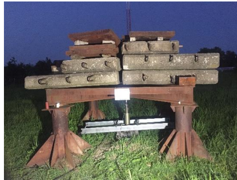
Figura 39 - Lest pentru executarea încercării de încărcare statică
