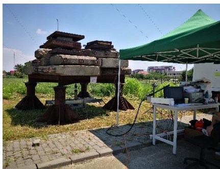
Figura 42 - Ansamblu încărcare și monitorizare încercare
