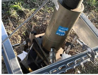
Figura 38 - Presă hidraulică pentru aplicarea încărcării statice
