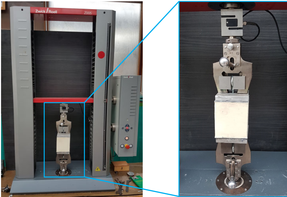
Error! Reference source not found. Fixarea epruvetei în mașina de testat
