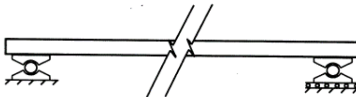
Fig. 1.2.3.8 Detaliu al rezemării panoului
