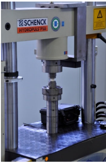
Fig. 1.2.1.1 Epruveta în bacurile de compresiune
