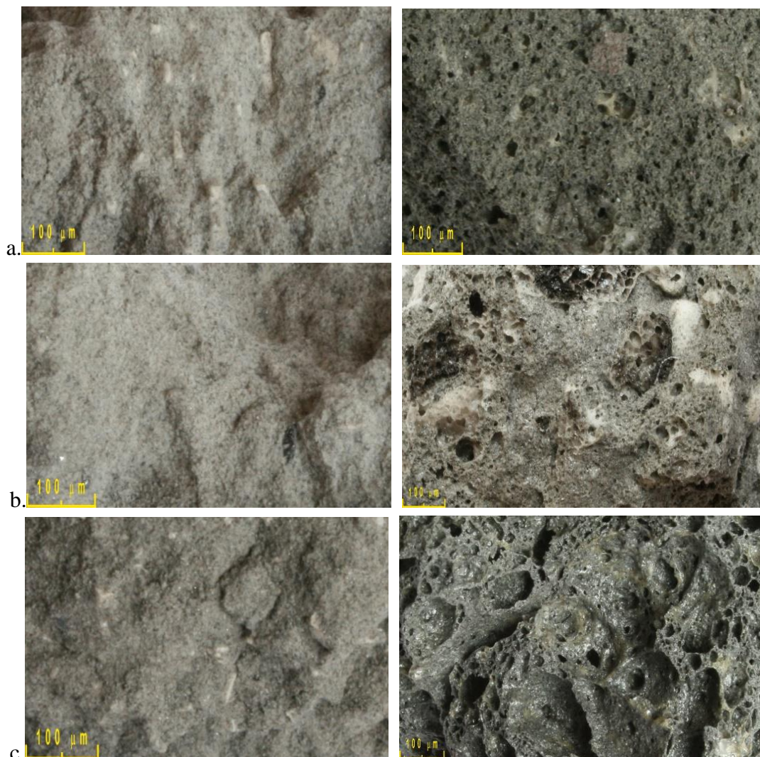
Figura 9. Imagini microscopice (mărire 50x) ale sticlelor celulare obținute la 900°C, timp de 5 și respectiv 10 minute pentru probele: a - S4; b - S5; c - S6.
